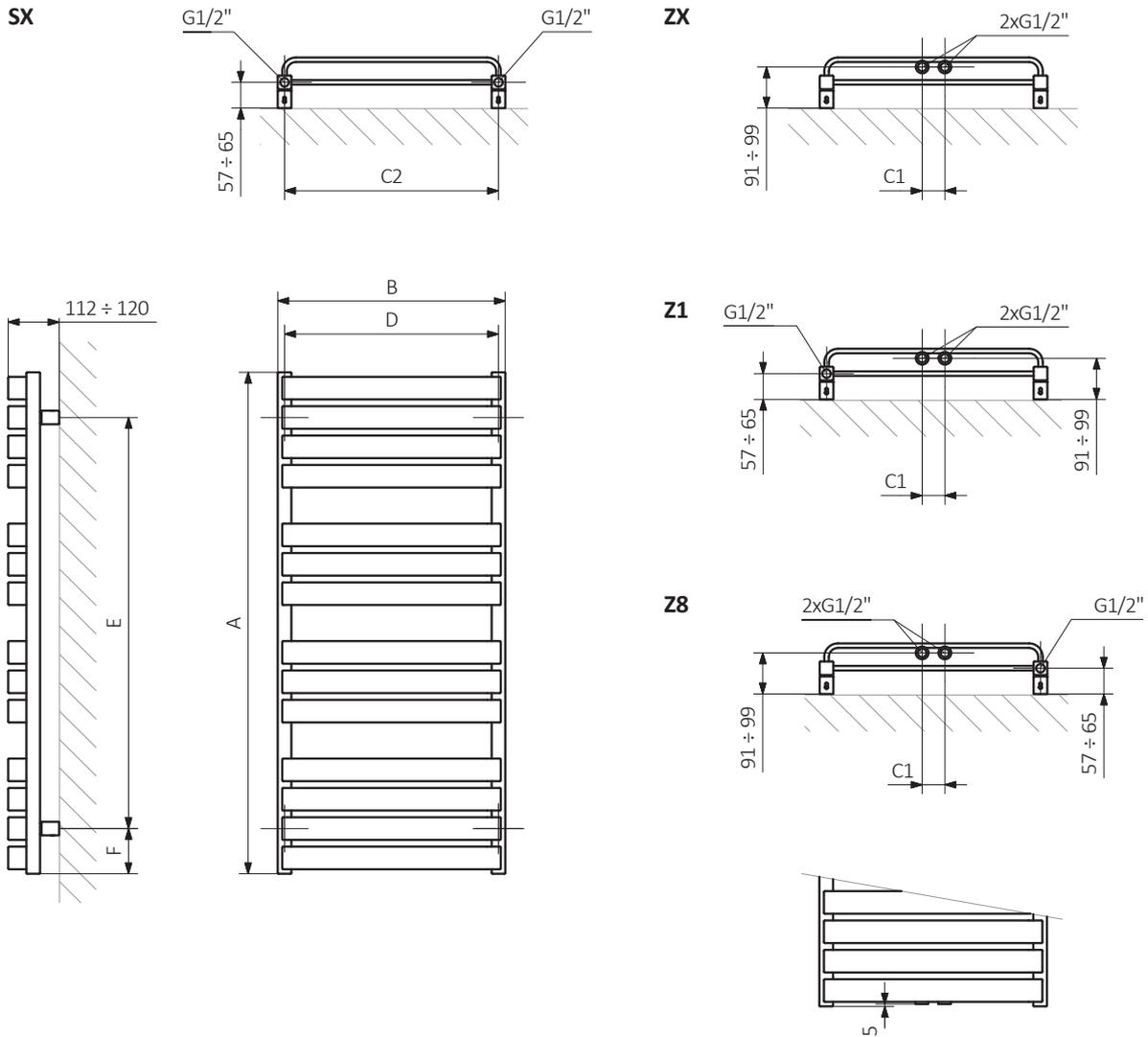
A – hauteur B – largeur C1-C5 – écartement des raccordements D – écartement des consoles en horizontal
