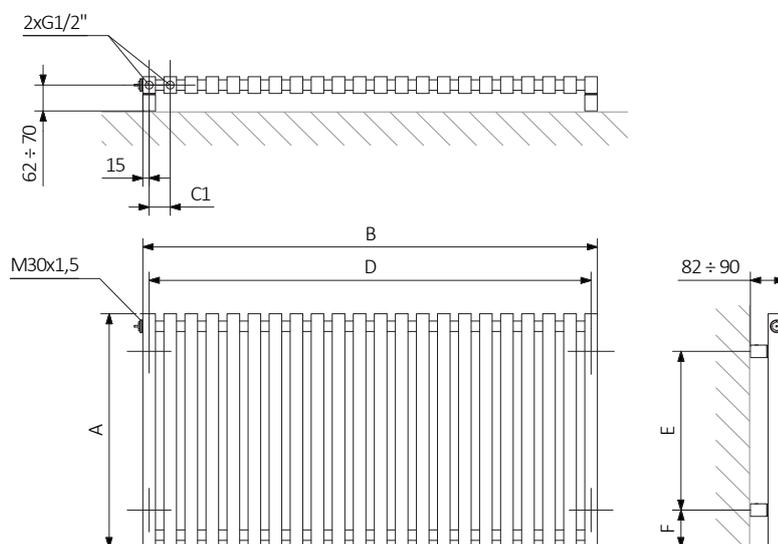
A – hauteur    B – largeur    C1-C5 – écartement des raccordements    D – écartement des consoles en horizontal    E – écartement des consoles en vertical    F – distance de l'axe de la console inférieure au bord inférieur du collecteur
