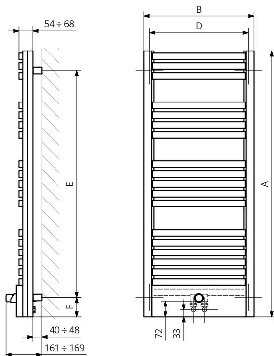
A – hauteur B – largeur C1-C5 – écartement des raccords D – écartement des consoles en horizontal E – écartement des consoles en vertical F – distance de l'axe de la console inférieure au bord inférieur du collecteur
