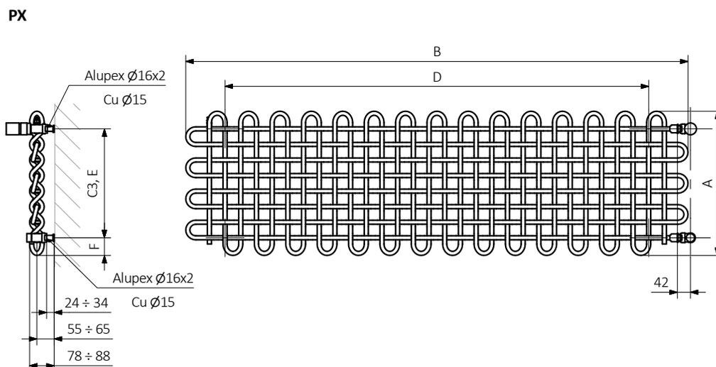
A – hauteur B – largeur C1-C5 – écartement des raccords D – écartement des consoles en horizontal E – écartement des consoles en vertical F – distance de l'axe de la console inférieure au bord inférieur du collecteur
