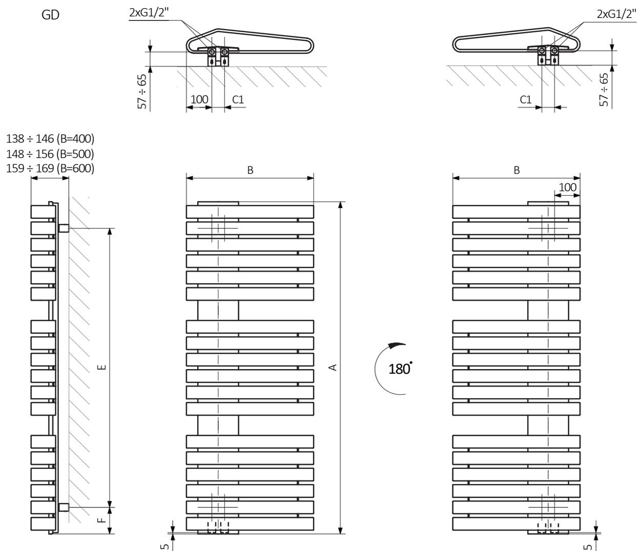
A – Hauteur B – Largeur C1-C5 – espacement des connexions D – espacement horizontal des attaches E – espacement vertical des attaches F – distance de l'axe inférieur des attaches au bord inférieur du collecteur
