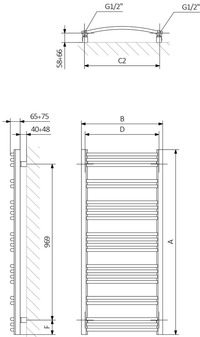
A – Hauteur B – Largeur C1-C5 – espacement des connexions D – espacement horizontal des attaches E – espacement vertical des attaches F – distance de l'axe inférieur des attaches au bord inférieur du collecteur
