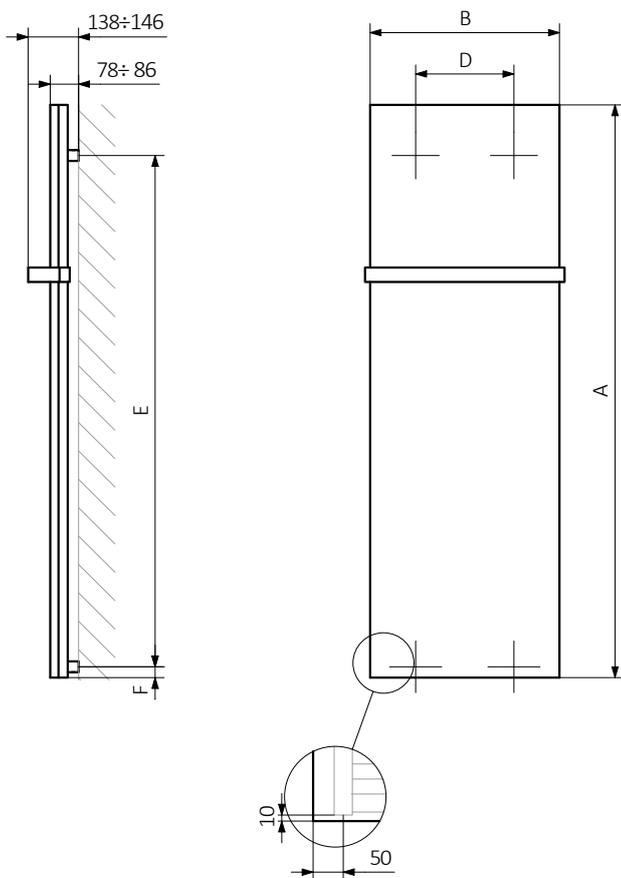
A – Hauteur B – Largeur C1-C5 – espacement des connexions D – espacement horizontal des attaches E – espacement vertical des attaches F – distance de l'axe inférieur des attaches au bord inférieur du collecteur
