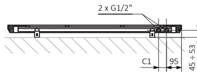
A – Hauteur B – Largeur C1-C5 – espacement des connexions D – espacement horizontal des attaches E – espacement vertical des attaches F – distance de l'axe inférieur des attaches au bord inférieur du collecteur
