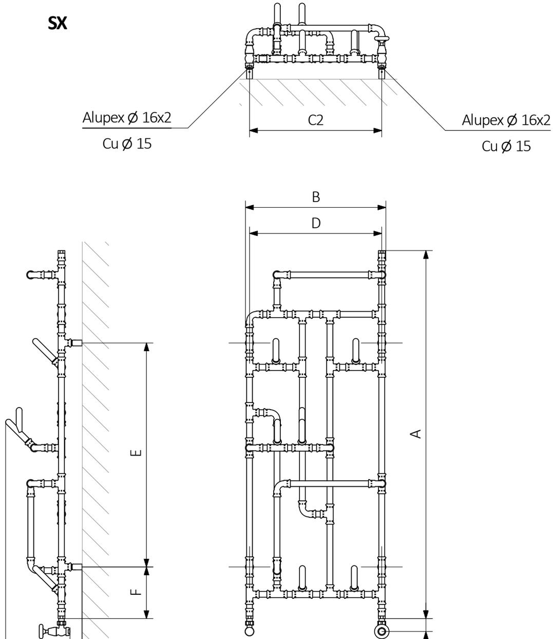
A – hauteur B – largeur C1-C5 – écartement des raccords D – écartement des consoles en horizontal E – écartement des consoles en vertical F – distance de l'axe de la console inférieure au bord inférieur du collecteur
