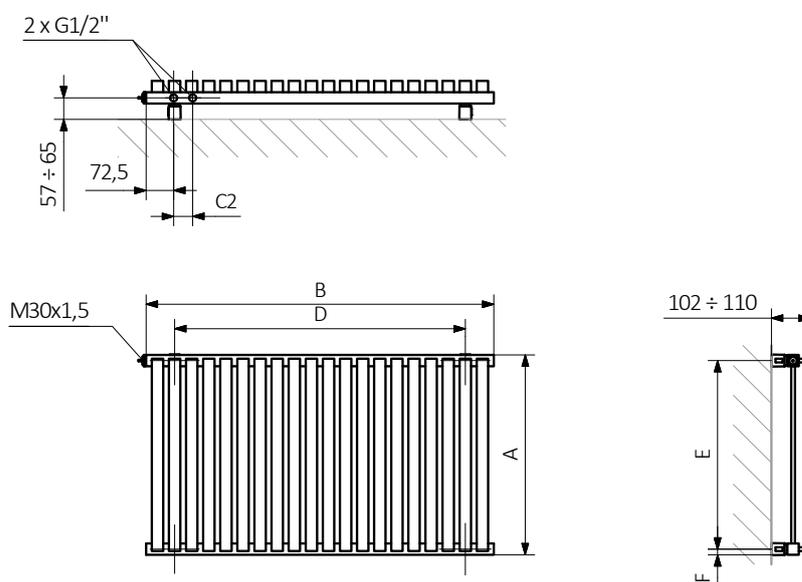
A – hauteur B – largeur C1-C5 – écartement des raccordements D – écartement des consoles en horizontal
