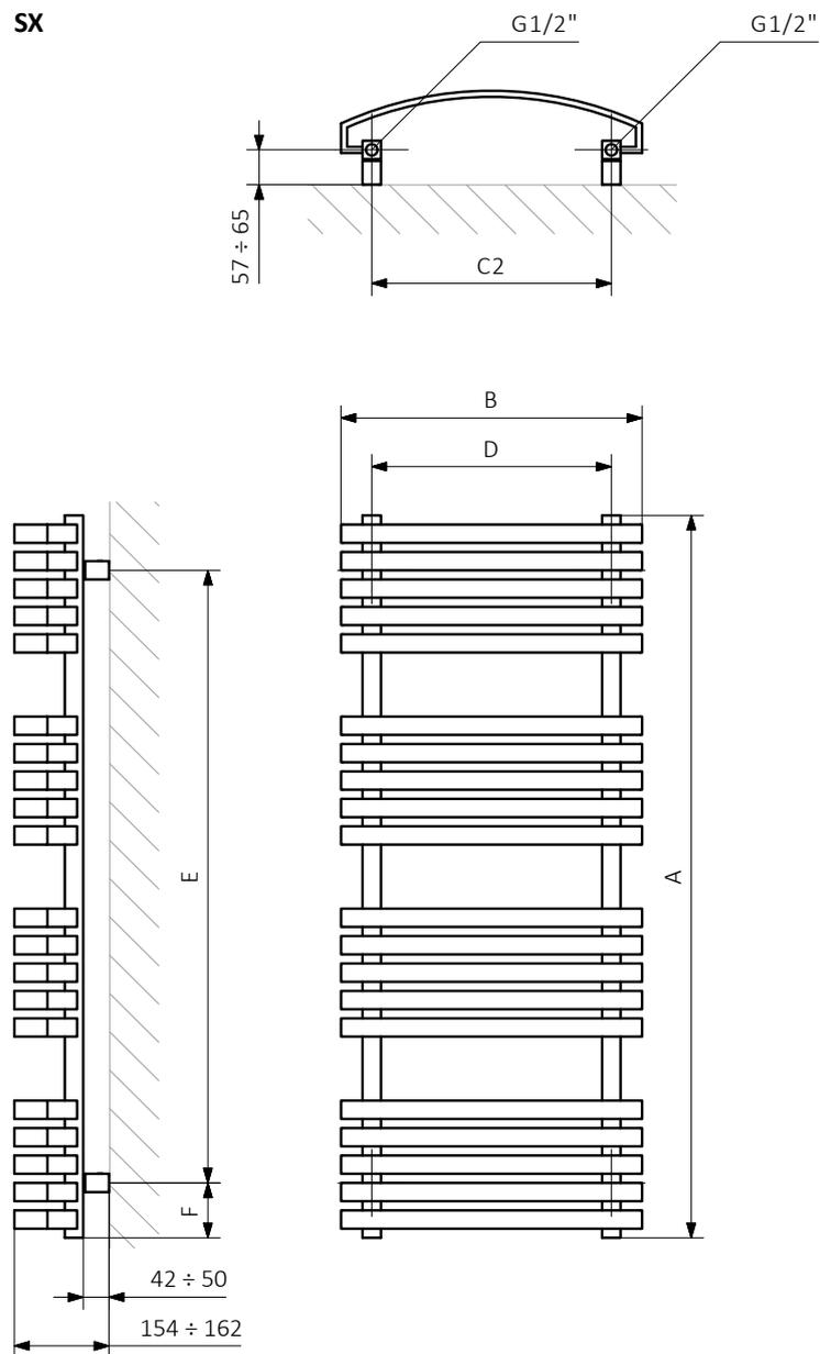
A – hauteur B – largeur C1-C5 – écartement des raccordements D – écartement des consoles en horizontal E – écartement des consoles en vertical F – distance de l'axe de la console inférieure au bord inférieur du collecteur
