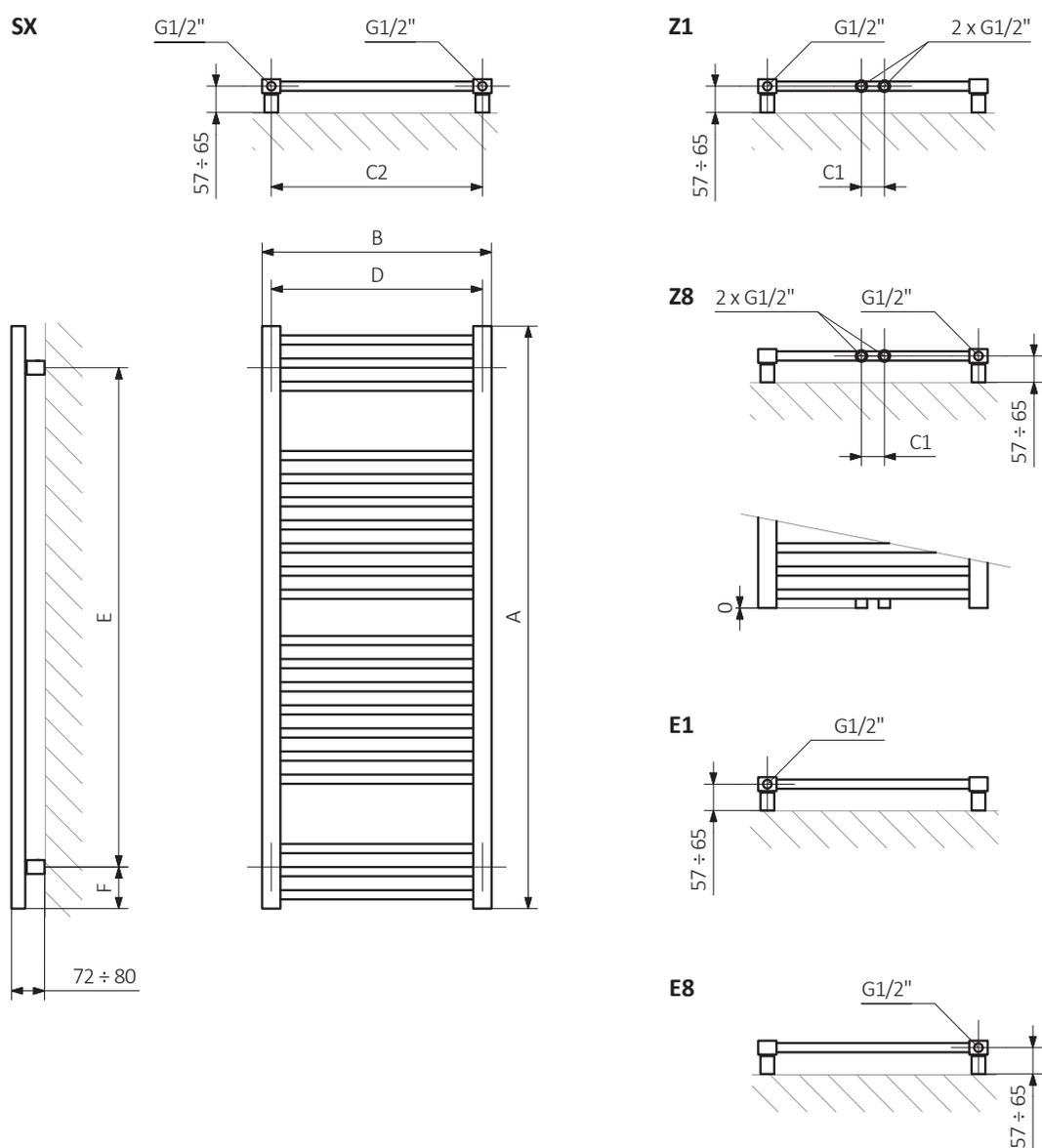
A – hauteur B – largeur C1-C5 – écartement des raccordements D – écartement des consoles en horizontal
