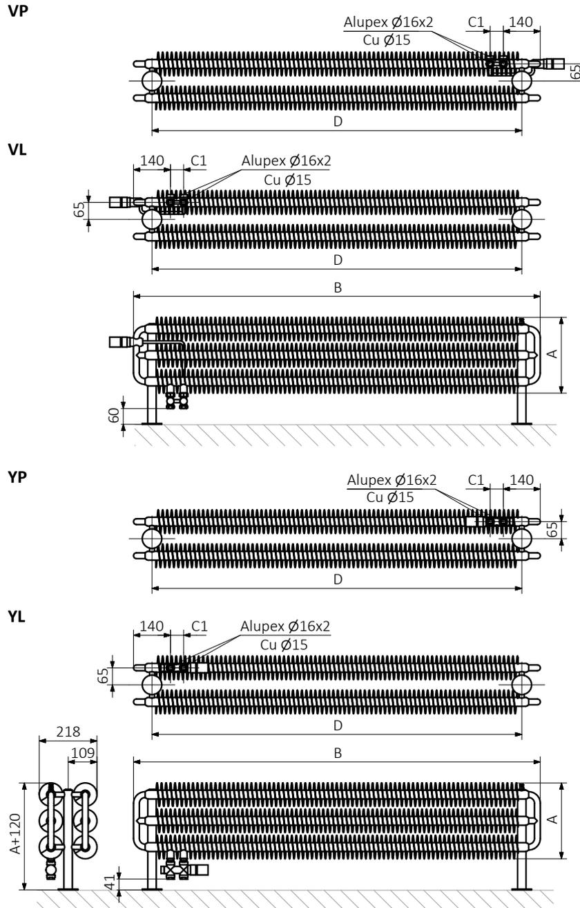
A – hauteur B – largeur C1-C5 – écartement des raccordements D – écartement des consoles en horizontal E – écartement des consoles en vertical F – distance de l'axe de la console inférieure au bord inférieur du collecteur
